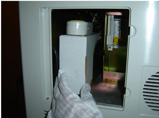
Para extraer el paquete de reactivos, desconecte la varilla de la parte superior del paquete de reactivos pulsando el botón amarillo de la varilla, que desconecta la varilla y el paquete de reactivos. Coloque la varilla sobre la superficie de la mesa sin que gotee. Extraiga con cuidado el paquete de reactivos utilizado en el analizador químico y deséchelo de la forma adecuada.
