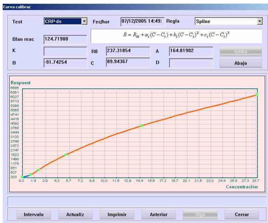
En el cuadro de diálogo **Curva calibrac**, seleccione un test del cuadro de lista desplegable **Test** para ver la curva de calibración.
