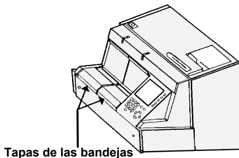
Fig. 3-1: Tapas de las bandejas del mini VIDAS
