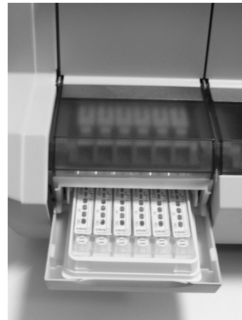
Fig. 2-8: Cartuchos colocados en la bandeja de preparación de cartuchos con su soporte
