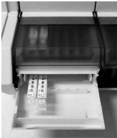
Fig. 2-7: Posición de los cartuchos en la bandeja de preparación de cartuchos
