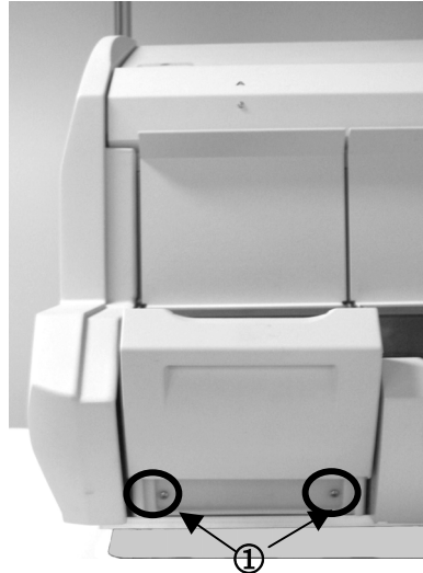
Fig. 8-6: Desmantelación de la bandeja de preparación de cartuchos
