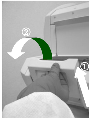
Fig. 8-4: Apertura de la bandeja de cartuchos
