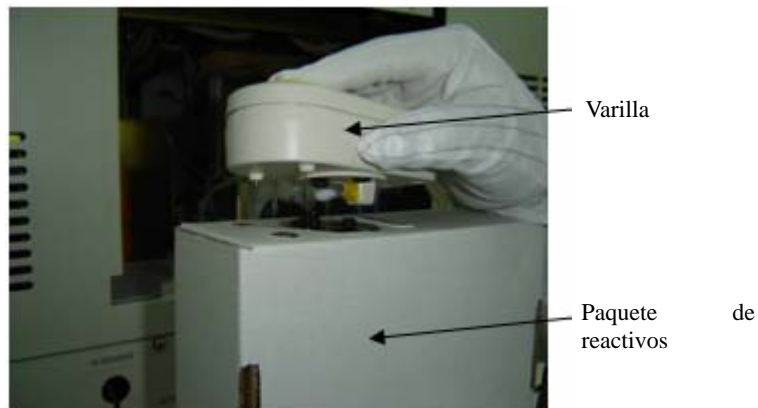
Figura 2-5 Instalación del paquete de reactivos Paso 1
