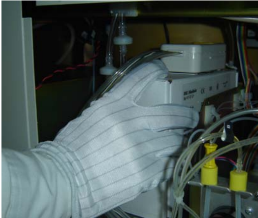
Figura 2-7 Instalación del paquete de reactivos Paso 3
